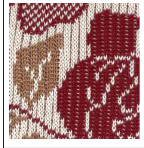
وجه القماش شكل (12) التجربة السابعة باستخدام أسلوب المخطط المفرغ من الخلف ظهر القماش
