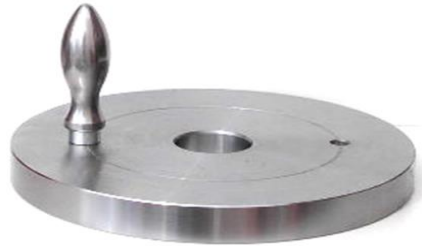
شكل (٦) السحاق (Muller) المستخدم في عملية تخشين القالب الطباعي بالكربورندم، مصنع من الزجاج السميك. والمعدن. (أحجام مختلفة من المولر لتناسب مع أحجام القوالب الطباعية المتنوعة. أشكال متنوعة والهدف الوظيفي واحد. ١
