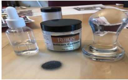
شكل (٦) السحاق (Muller) المستخدم في عملية تخشين القالب الطباعي بالكربورندم، مصنع من الزجاج السميك. والمعدن. (أحجام مختلفة من المولر لتناسب مع أحجام القوالب الطباعية المتنوعة. أشكال متنوعة والهدف الوظيفي واحد. ١
