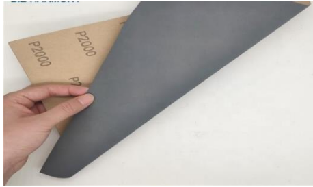
شكل ( ٤ ) ( ٥ ) نموذج لورق الكربوراندوم ويتوفر تجاريا بمجموعة من الأرقام التجارية تدل على مدى النعومة والخشونة ، ونسخة طباعية للباحثة مستخدمة أوراق الكاربورندوم فى الخلفية عن طريق أسلوب التنقيط ١
