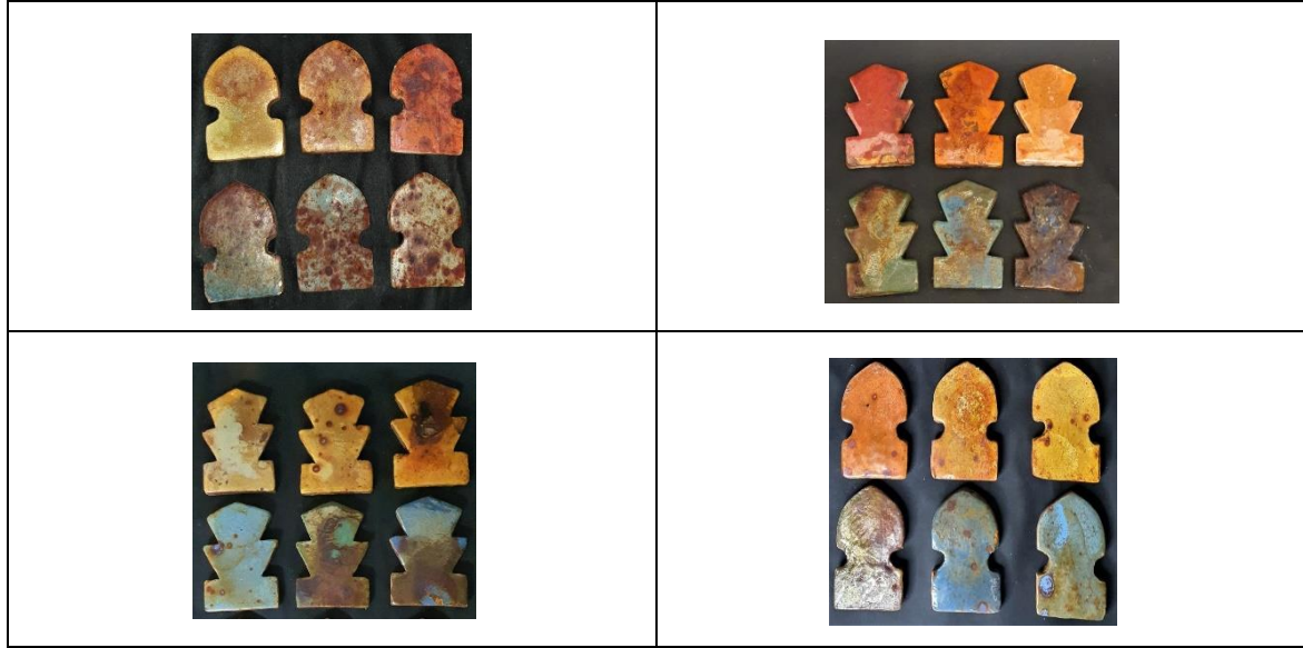
جدول (١٨) يوضح مجموعة من انتاج التجارب مع مجموعه مختلفه من الطلاءات الزجاجيه (الامع- المطفي),(الشفاف-المعتم)
