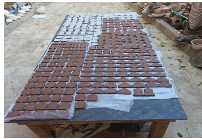
شكل (١) توضح مرحله تطبيق البطانة التيراسيجلاتا بلون ابيض لجمع عينات التجربة
