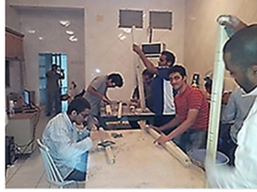
(شكل 19) يوضح عمل الطلبة بمرحلة التشطيب المبدئي لأجزاء المشروع بالصنفرة الخشنة
