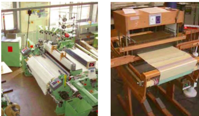
شكل رقم (2) يوضح نسج الألياف الضوئية يدويا وأليا
