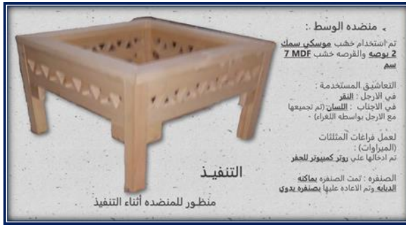
(شكل ٥٥) مراحل تنفيذ منضدة الوسط المستخدمة في الكوان الخاص بمنطقة الإستقبال بالفندق خمس نجوم.
