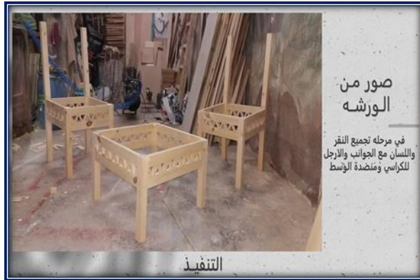
(شكل ٥٧) توضح مراحل تنفيذ الكروسي ومنضدة الوسط المستخدم في الكوان الخاص بمنطقة الإستقبال.
