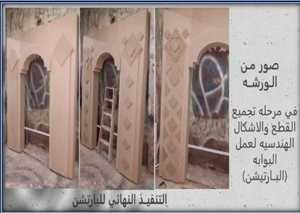
(شكل ٥٩) مراحل تنفيذ البارتيشن المستخدم في الكوان الخاص بمنطقة الإستقبال بالفندق خمس نجوم بأسوان.
