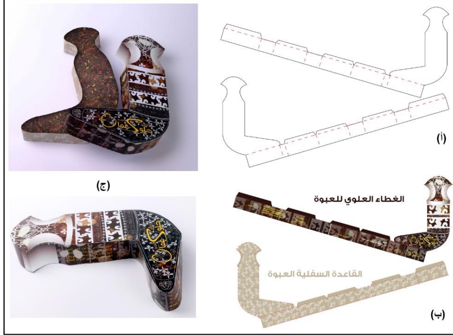
شكل (3 أ) التصميم البنائي للعبوة بشكل الخنجر شكل (3 ب) التصميم الجرافيكى للعبوة بشكل الخنجر شكل (3 ج) الشكل المنظوري للعبوة
