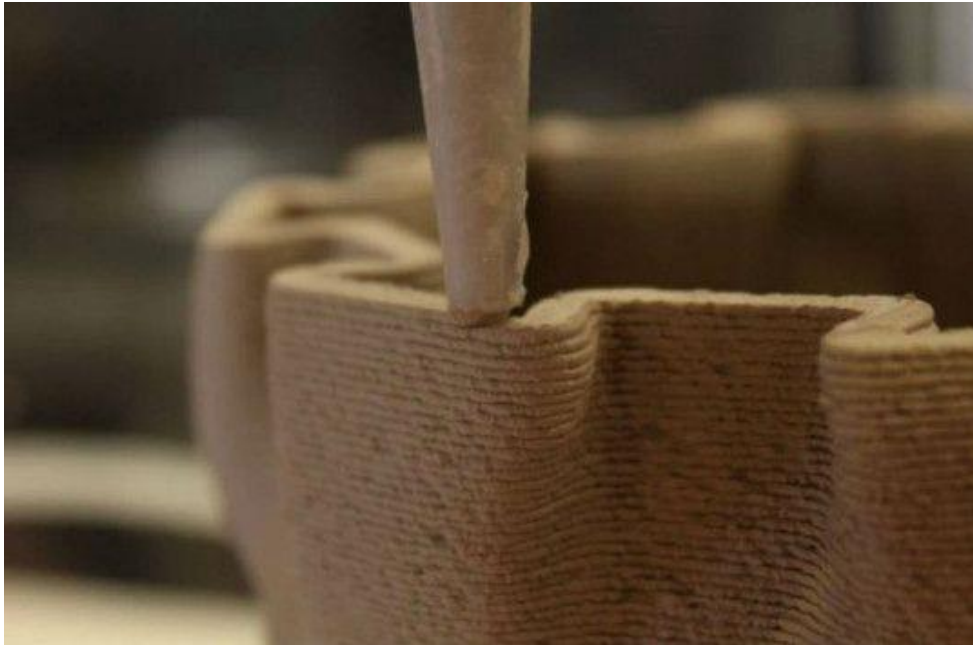
شكل ١ توضيحي يظهر أحد القطع الخزفية أثناء الطباعة
