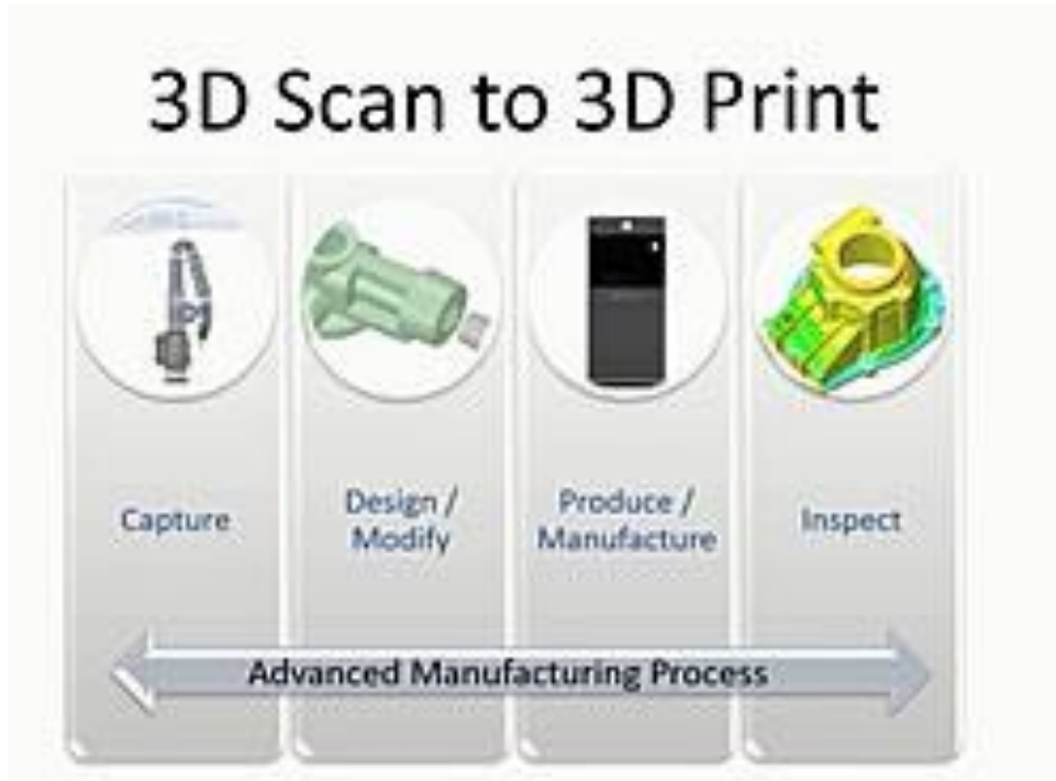
شكل ٨ توضيحي يظهر خطوات الهندسة العكسية
