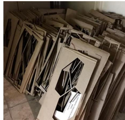
(شكل ١٣) مراحل العمل المختلفة بالمجموعة بداية من النموذج التخيلي للفكرة علي برنامج 3Dmax ثم عملية الافراد لاسطح علي برنامج AutoCAD ثم مرحلة التقطيع لالواح الكرتون بالمقاسات المحددة. المصدر : تصوير مجموعة العمل
