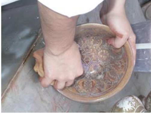
شكل رقم (13) تنظيف المنتج بالماء جيدا للتخلص من الشوائب العالقة لإظهار رونق وجمال الزخارف ذات البريق المعدني
