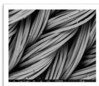
شكل 5 صورة باستخدام مجهر الماسح الإلكتروني (SEM) لألياف البولي استر غير المعالجة.
