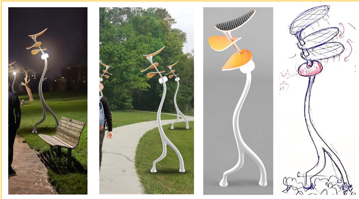
شكل رقم (١٨): نموذج لوحدة إضاءة شمسية تثبت بالحدائق، مستلهم من شكل افرع وسيقان وأوراق النباتات، حيث تتواجد الخلايا الشمسية على شكل ورقة أعلى الوحدة وهي مثبتة على مفصل كروي حتى يمكن تدويرها في اتجاهات الشمس (إعداد الباحثين)
