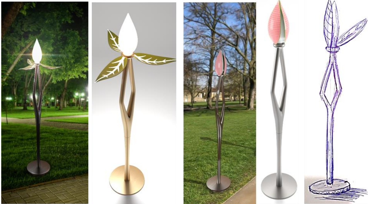
شكل رقم (١٦): نموذج لوحدة إضاءة تثبت بالحدائق وتعمل بالطاقة الشمسية، مستلهم من شكل الزهرة، حيث تتواجد الخلايا الشمسية على أوراق الزهرة والتي تأخذ شكلاً مخروطياً يمكنها من أسر أكبر قدر من طاقة الشمس طوال اليوم، والتي يمكن طيها وفردها، حيث تفتح تلقائياً عند حلول الظلام من خلال حساس ضوء يتحكم في حركة موتور صغير يفتح أوراق الزهرة ومن ثم يضيء المصباح (إعداد الباحثين)
