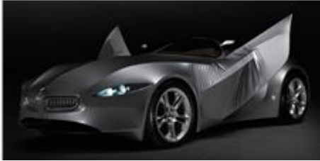
شكل (٨): يوضح عناصر جسم السيارة قابلة للحركة
