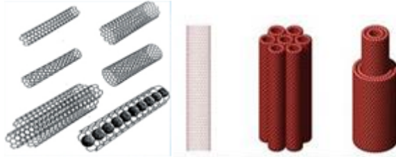
شكل (٢) يوضح أنابيب النانو كربون المستخدمة في أجهزة النانو(٧)
