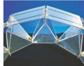
شكل (٢٧) استخدام الألواح الزجاجية كعنصر حامل مع نظام الكابلات
