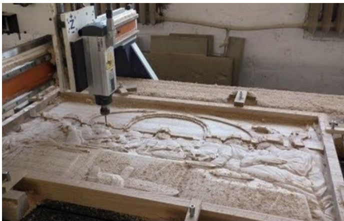
شكل(٩) آلة القطع الهيدرولوكية أو الرووتر (Router)
