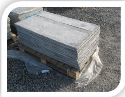
صورة (١٣) توضح خامة الجي آر سي وتشكيلاتها المتعددة في الواجهات
