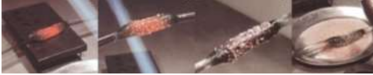
شكل (13) خطوات تشكيل المنتج الزجاجي المغلف بالكسر الزجاجي (الفرت) أو بملونات المينا
