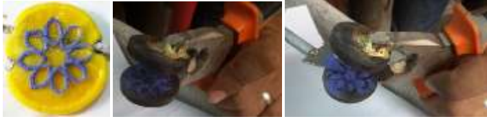
شكل (44) تشكيل منتج زجاجي بضغط الزجاج داخل الماشة المعدنية ذات التجويف النحتي المملوء بالمينا
