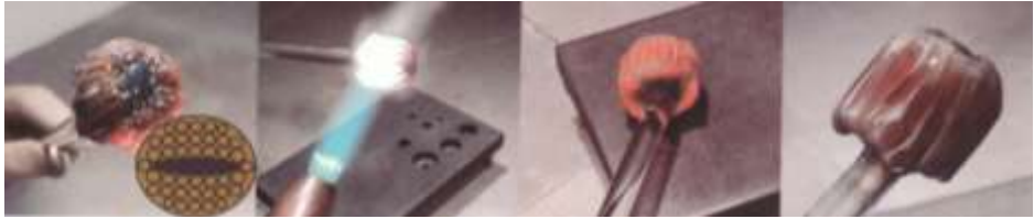
شكل (8) خطوات تشكيل وحدات الموازيك
