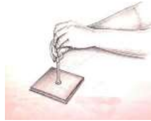
شكل (23) تسوية الزجاج بالضغط على لوح التسوية
