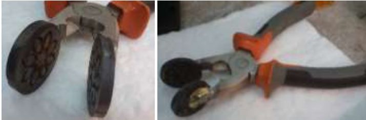
شكل (42) الماشة المعدنية المنفذة ذات التشكيل الزخرفي الإسلامي الهندسي
