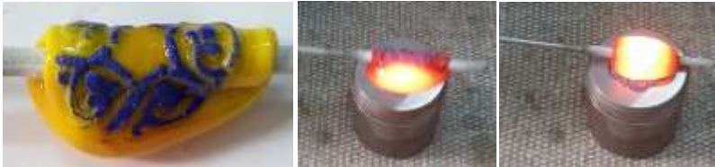
شكل (38) خطوات تشكيل منتج زجاجي بدوران الزجاج على القالب ذو التجويف النحتي المملوء بالمينا
