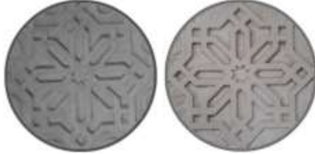
شكل (30) نموذج جصي وقالب تشكيل حراري يمكن استخدامه في التشكيل بالمشعل الحراري
