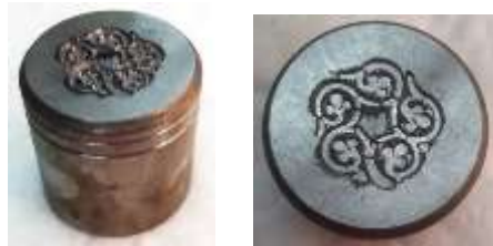
شكل (34) القالب المعدني المنفذ من الحديد الصلب لتشكيل الزجاج
