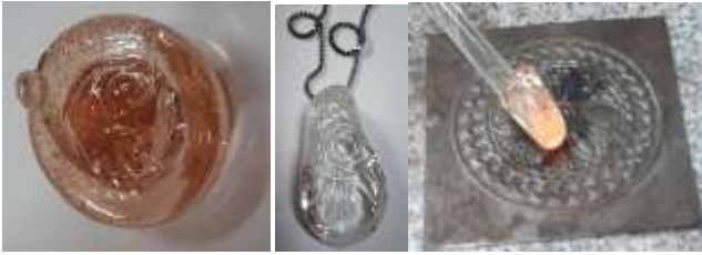
شكل (46) عمل تشكيلات بارزة في الزجاج باستخدام الأدوات المسطحة ذات التشكيلات الزخرفية النحتية
