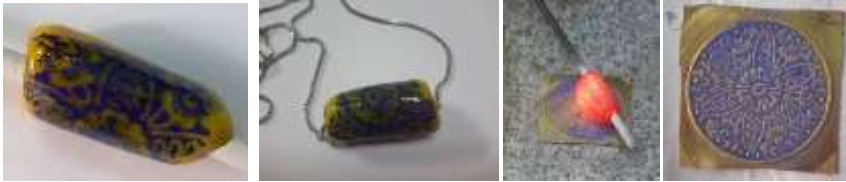
شكل (47) خطوات تشكيل منتج زجاجي بدوران الزجاج على الأداة المسطحة ذات التجويف النحتي المملوء بالمينا
