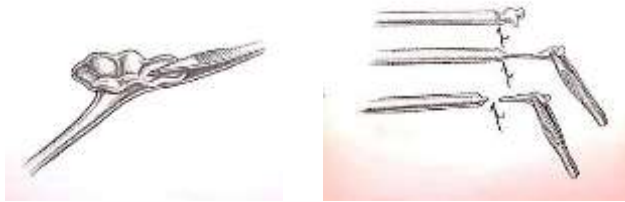
شكل (25) استخدام الملاقيط لإزالة الزوائد وللتثني في أطراف المنتج
