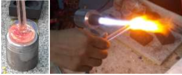
شكل (35) مراحل استخدام قالب الحديد الصلب المنفذ في تشكيل الزجاج باستخدام المشعل الحراري
