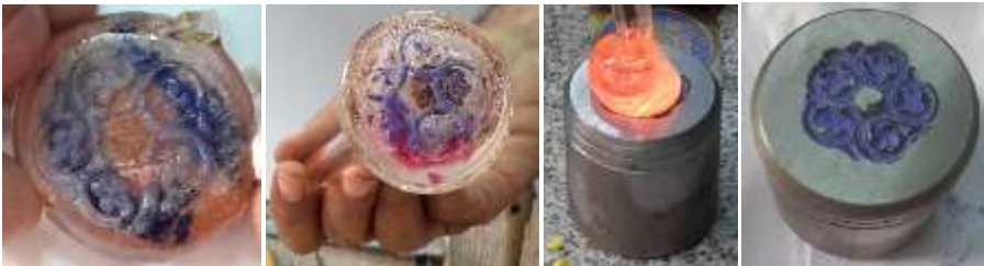
شكل (37) خطوات تشكيل منتج زجاجي بضغط الزجاج على القالب ذو التجويف النحتي المملوء بالمينا
