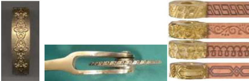
شكل (40) بعض أشكال عجلة التشكيل بالضغط
