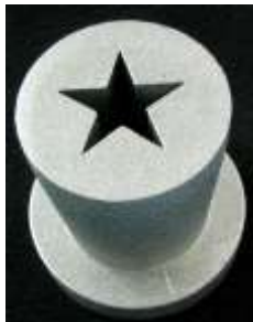
شكل (31) قوالب معدنية ذات تشكيلات نجمية يمكن استخدامها في تشكيل أعمدة موزاييك تحمل الطابع الإسلامي
