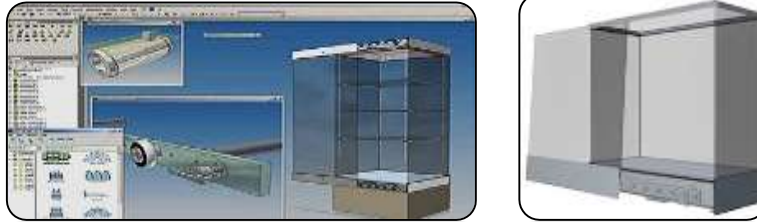
شكل رقم ( 35 ) نموذج افتراضي لإحدى الشركات المتخصصة (1) لوضع الأقفال السفلية وكيفية إخفائها بألواح الزجاج المتحركة لوحدة العرض الزجاجية.
