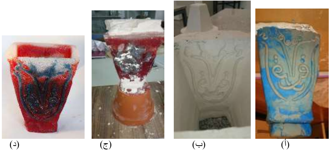
شكل (14) مراحل تنفيذ التصميم الثالث: (أ) نموذج من الصلصال . (ب) القالب الحراري . (ج) المنتج قبل التشطيب . (د) المنتج النهائي.
