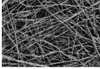
شكل (3) يوضح الألياف الدقيقة لشبكة ال Melt Blown (14)
