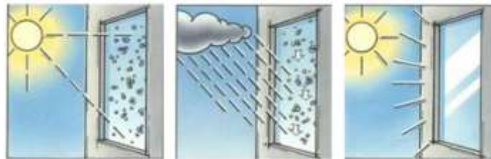
( صورة 8 أ ، ب ، ج ) توضح قطرات الماء المكثفة وامكانيات الزجاج ذاتى التنظيف المعالج بخاصية ( Photo catalysis ) على التخلص الدائم منها وبشكل فوري . Sylvia,leydecker,Nanomaterials in architecture, interior architecture and design,Princeton Architectural Press, NY, USA, 2008.
