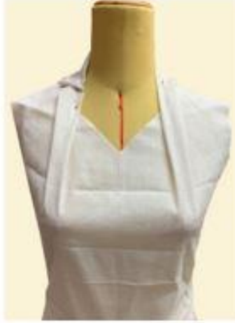
صورة (١١) إعادة وضع القماش على المانيكان وتشكيل الجزء العلوي من الكول تايلور.
