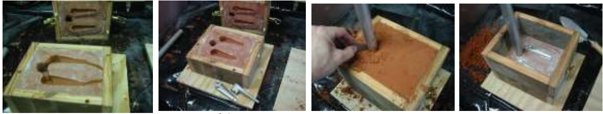
شكل ( 5 ) مراحل تجهيز نظام التغذية
