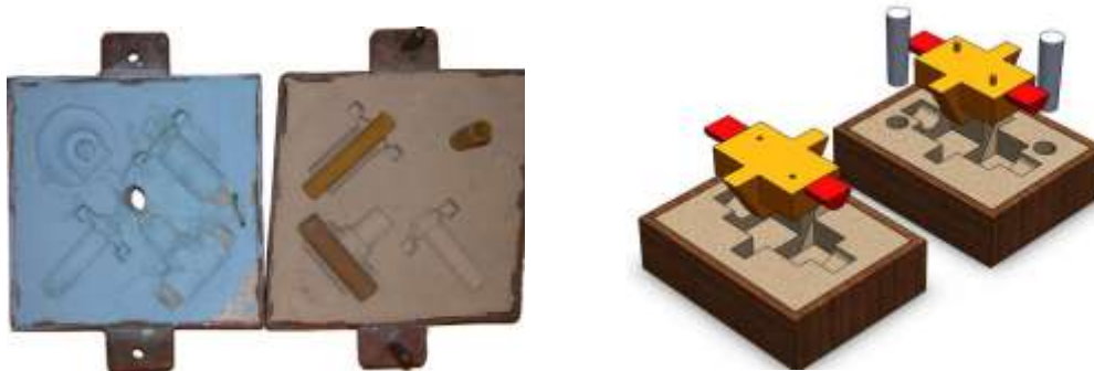
شكل ( 4 ) إعداد فجوة القالب الرملي وتثبيت القلب ( الداليك )
