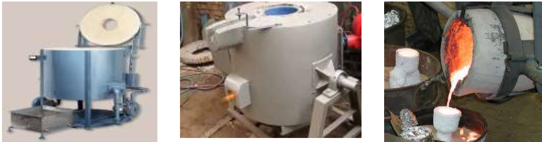
شكل (6) بعض الأنواع المختلفة لأفران صهر المعادن
