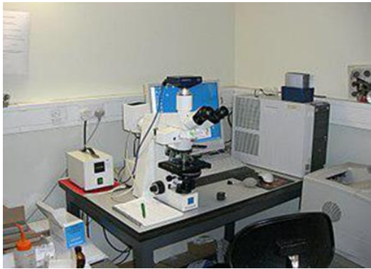
شكل (4) مجهر بصري حديث مع لمبة زنبقية على كاميرا رقمية متصلة بجهاز كمبيوتر (1996 Rosenthal) وعلى اليمين مجهر Olympus-E القديم (1000X.10 science-) (2021 photomicrography)
