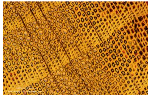
شكل (29) صورة مجهرية توضح مقطع من خلال شجرة صلبة من شريحة مُعدة بالفحص المجهرى للضوء المستقطب x200 (microscopicplants1 2020)
