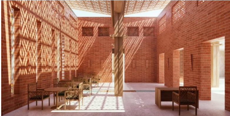
شكل (٢٧): الصحن الداخلي المؤدي إلى مكتبة الكبار، ويظهر السقف الخشبي المستوحى من الملقف في العمارة المصرية القديمة، ونرى انعكاس زخارف السقف على الجدران والتي تتغير بحسب حركة الشمس. كما يظهر فتحات علوية في الجدران تساعد على التهوية الطبيعية للحيزات المجاورة. المصدر: تصميم الباحثة.
