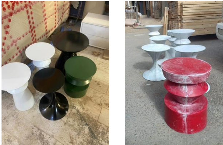
شكل (١٣) يوضح صور لمجموعة من المناضد الجانبية بتصميمات متنوعة والمصنعة بنفس التقنية ، ويظهر المنتجات قبل وبعد التشطيب النهائي. المصدر : الباحثة
