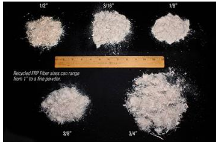
شكل (١٦) يوضح صورة للألياف الزجاجية بعد التقطيع والطحن تمهيداً لإعادة تدويرها
