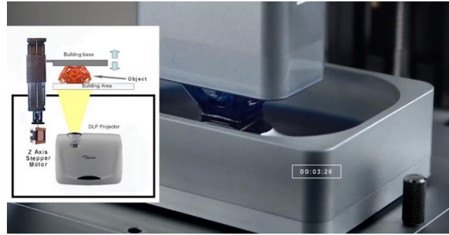
شكل (٤) يوضح صورة لأحد أنواع الطباعات الضوئية (DLP)
