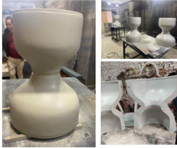
شكل (١٢) يوضح صور لأحد المناضد الجانبية المصنعة بنفس التقنية ، ويظهر شكل القالب الفايبرجلاس والمنتج قبل وبعد التشطيب النهائي. المصدر : الباحثة
