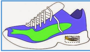
شكل (٢٩) تحويل الطاقة الحركية للمشي إلى طاقة كهربائية باستخدام تقنيات الطاقة الانضغاطية
