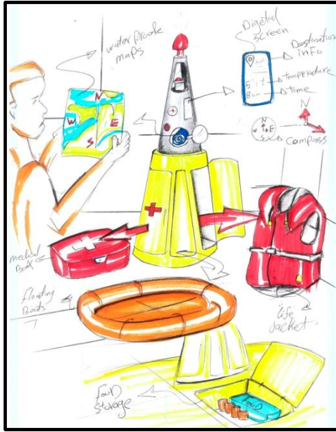
شكل (٣٣) اسكتش توضيحي لتصميم شمندورة بحرية تعمل بالطاقة الموجية
