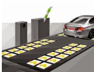
شكل (٢٨) تحويل الطاقة الحركية للسيارات إلى طاقة كهربائية باستخدام تقنيات الطاقة الإنضغاطية
