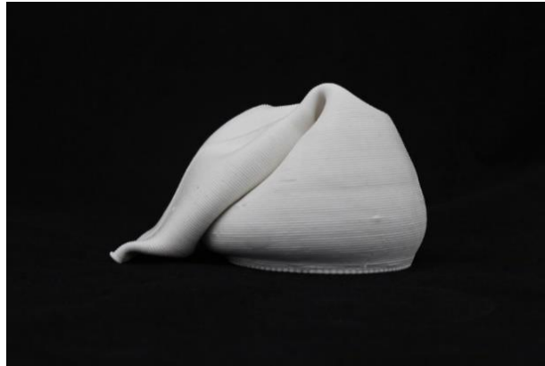
صورة رقم ٢ توضح انهيار أحد القطع المشكل أثناء الطباعة ثلاثية الأبعاد (net 5)
