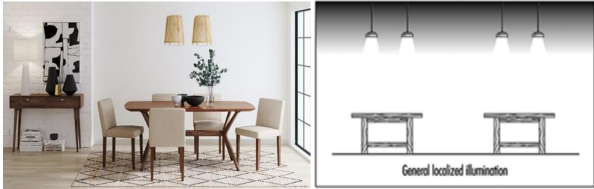
صورة رقم ٤ توضح إضاءة عامة فوق منضدة طعام (net 8)
