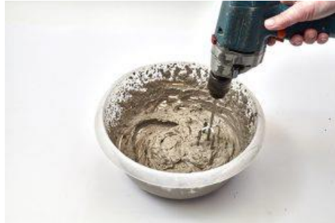
صورة رقم ٨ توضح الخلط الجيد لتركيبة جسم طينات الورق
