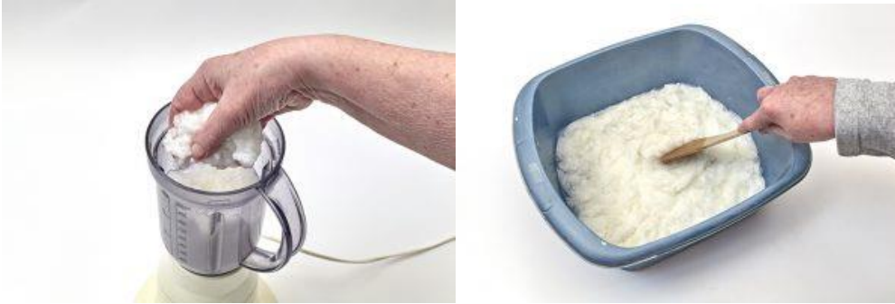
الصور رقم ٦ توضح ترك الورق في الماء لمدة كافية ٢٤ ساعة ثم التقطيع باستخدام الخلاط
