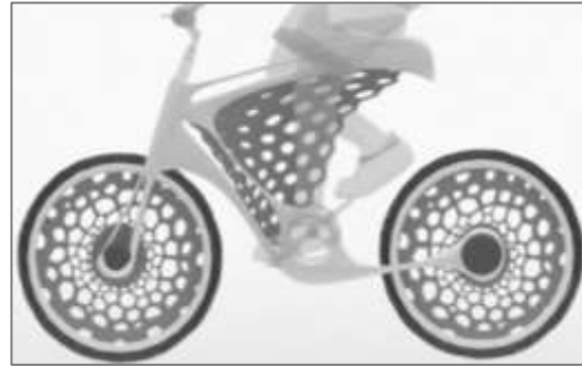
شكل (20-أ) إستلهام من الطبيعة لتشكيلات فوروبوي ثلاثية الأبعاد في تصميم دراجة
