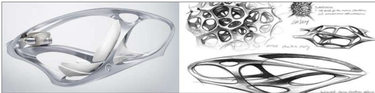
شكل (13) نموذج Aesthetics No.2 لسيارة مرسيدس يوضح الاستلهام من التكوينات البارامترية لبناء هيكل المنتج
