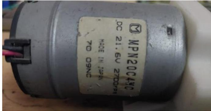
شكل (١١) يوضح لوحة الموتور المستخدم
