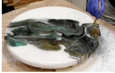
صورة ٤ دهان سطح طاولة بتأثير الرخام باستخدام خامة الإيبوكسي ريزن
