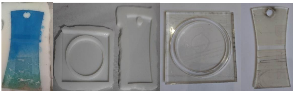
صورة 15 قالب ظهر المقعد والقاعدة من الأكريليك - صورة 16 قوالب المقعد من السليكون - صورة 17 صب الريزن بالقالب بالتشكيل المطلوب
