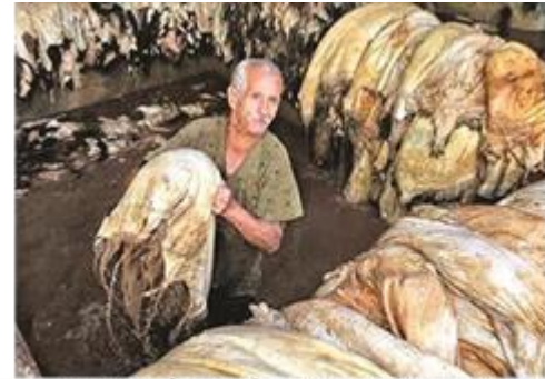
صورة رقم (٤) توضح الطريقة التقليدية لتجميع و غسل الجلود قبل مراحل الدباغة و تأثير ذلك على بيئة المنطقة لعدم وجود شبكة صرف صناعي جيدة .
