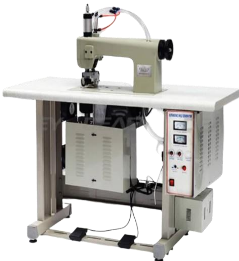
شكل رقم (٢) يوضح مكونات ماكينة الحياكة بالموجات فوق الصوتية https://arabic.alibaba.com/product-detail/Nonwoven-Fabric-Woven-Sealing
