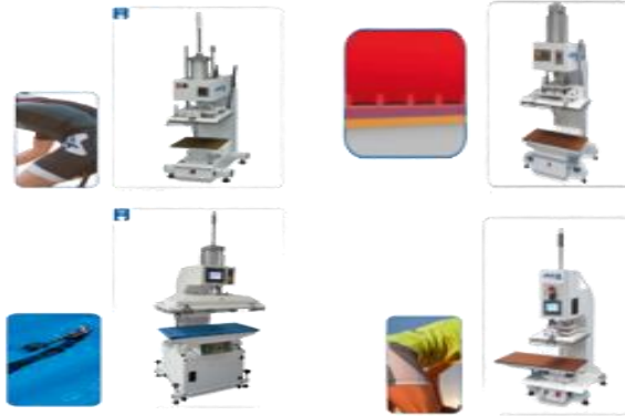
شكل رقم (٥) يوضح الحياكة بالموجات فوق الصوتية عن طريق الضغط
