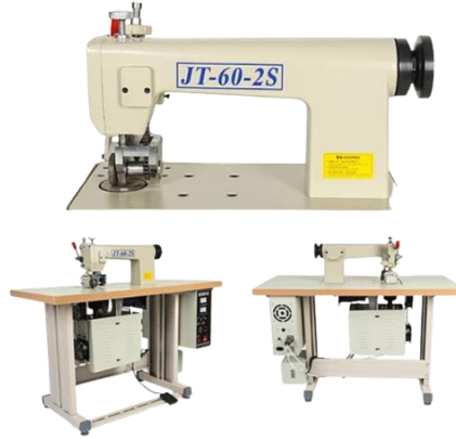
شكل رقم (٤) يوضح الحياكة بالموجات فوق الصوتية عن طريق اللحام (Welding Ultrasonic) (Radhakrishnan, Shanthi, and Devendra Kumari 2017)
