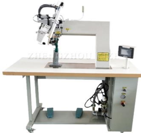
شكل رقم (٣) يوضح الحياكة بالموجات فوق الصوتية باستخدام شريط (Sealing Seam/BondingTape)
