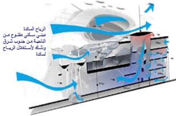
(شكل ٥) قطاع في مبنى سكني يوضح كيفية استخدام وردة الرياح في تصميم الحيزات المعمارية، وكيفية وضع المبنى
