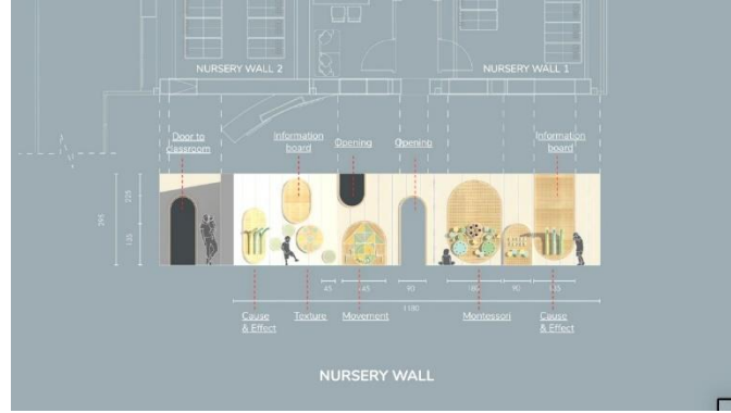
شكل (١١) يوضح التفاصيل الخاصة بالمعالجات الخاصة بالجدار السابق من حيث المعطيات المعمارية والمقاسات.
