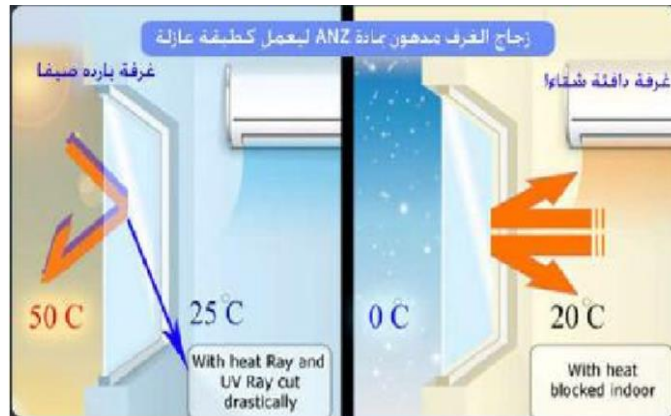
شكل رقم (٧) يوضح زجاج العرف المعالج بمادة النانو وتأثيره شتاء وصيفا
