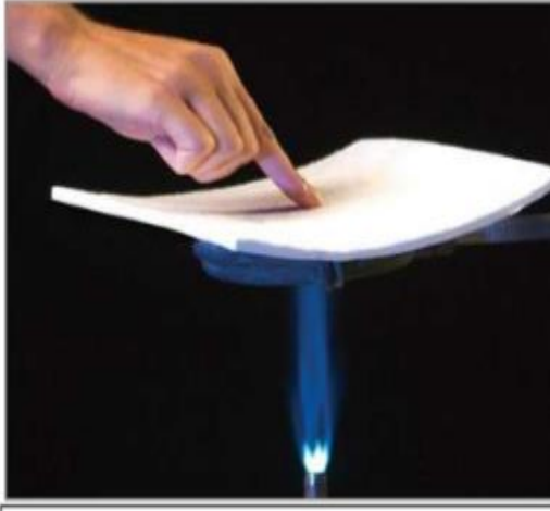
شكل رقم (٦) مقدار طبقة رقيقة من الهلاميات الهوائية في منع انتقال حرارة الشعلة الملتهبه.
