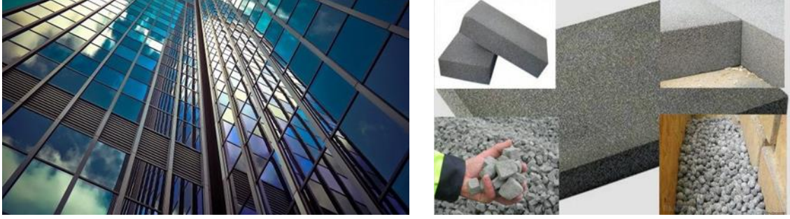
صورة رقم (١٠) توضح استخدام الزجاج الرغوى في عملية الإنشاء
