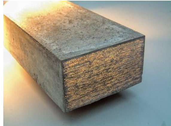
صورة رقم (٤) توضح استخدام الخرسانة الشفافة في عملية الإنشاء لخلق واجهات حيوية وديناميكية، وكذلك الحد من استهلاك الطاقة للإنارة
