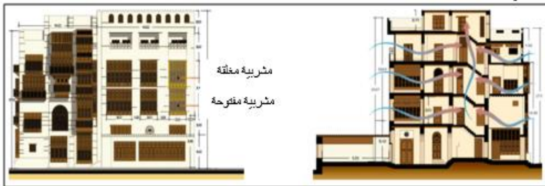
الشكل ٦. يوضح الجانب الوظيفي للمشربية: الحماية من أشعة الشمس، وتنظيم الإضاءة، وتقليل ضوء الشمس، والتهوية.
