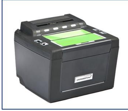
شكل رقم (٣) يوضح جهاز مسح البصمات Cross match المستخدم في عملية المسح الضوئي للبصمة الشخصية المستخدمة في هذه التجربة.
