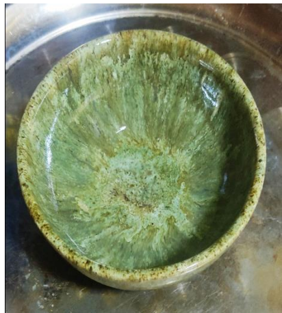
شكل رقم (٧) يوضح الشكل الخزفي مع الطلاء الزجاجي تينموكو قبل القيام بوضع حمض الخليك
