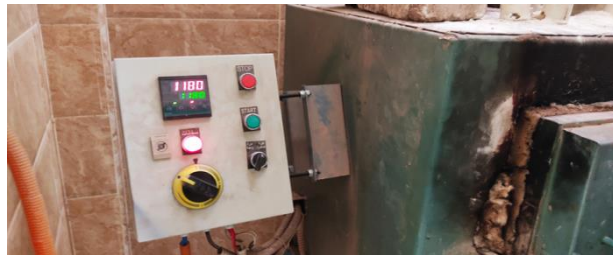
صورة توضح الوصول لدرجة الحرارة المطلوبة (١١٨٠م) كما هو مبين بالجدول رقم (٤)
