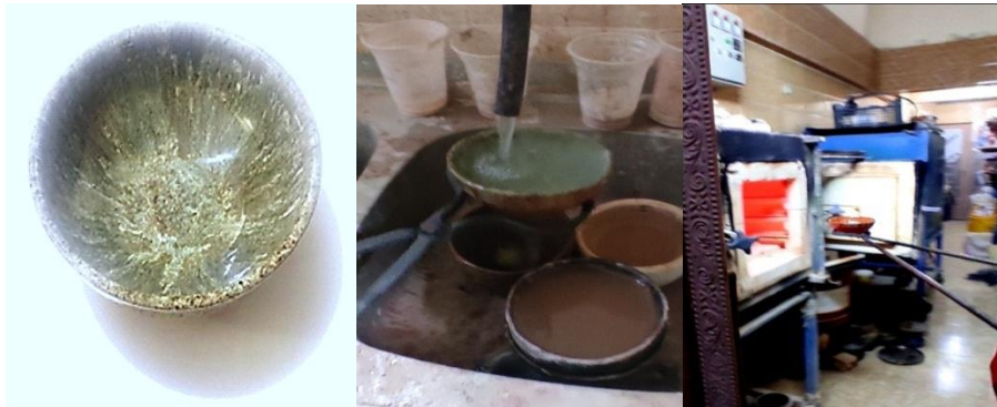
شكل رقم (٦) يوضح القيام بصدمة حرارية على الشكل الجسم الخزفي بتطبيق الطلاء الزجاجي تينموكو على درجة حرارة ١٧٠°م
