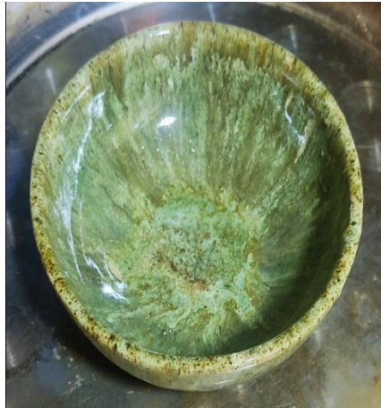
شكل رقم (٩) يوضح الشكل الخزفي تينموكو بعد مضي ٥ ساعات من وضع حمض الخليك داخله
