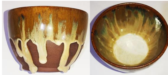
شكل رقم (١٠) تجربة رقم (٢) استطلاعية بولية من طينات حرارية (ارتفاع ١٠سم، عرض ١١سم، قاعدة ٧سم) طلاء زجاجي تينموكو (اكسيد حديد، اكسيد تيتانيوم، زنك) درجة حريق ١١٧٠م°، تثبيت حراري ٣٠ دقيقة
