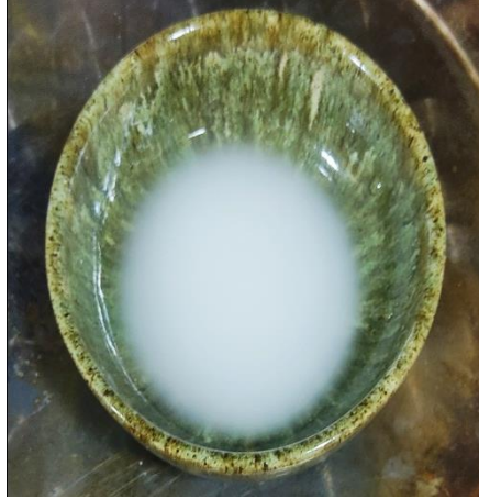
شكل رقم (٨) يوضح سكب حمض الخليك مع ١ جم لون ابيض لاطهار الحمض من الشكل مع استمرار الحمض لمدة ٥ ساعات
