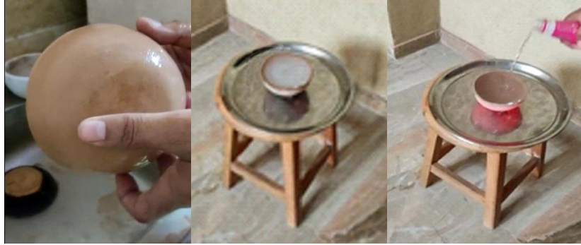
شكل رقم (٥) يوضح القيام بصدمة حرارية شكل بولة من طينات حرارية، جدول رقم (٤) (ارتفاع ٧سم، عرض ١٠سم، قاعدة ٦سم)
