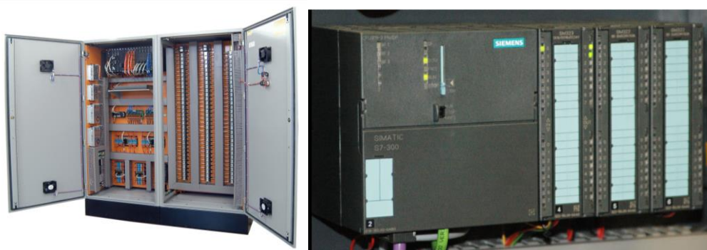
شكل (٨) يوضح جهاز التحكم المنطقي القابل للبرمجة
