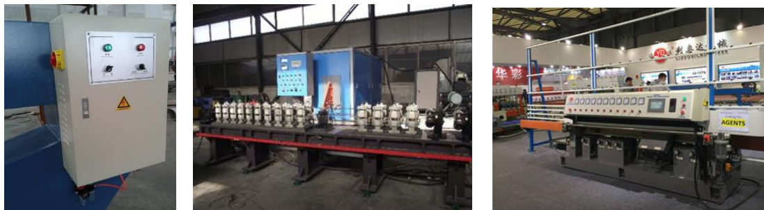
شكل (٩) يوضح جهاز التحكم المنطقي القابل للبرمجة في ماكينات خاصة بصناعة الزجاج
