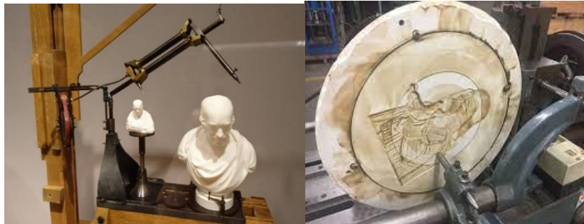
شكل (٣) طريقة عمل جهاز البانتوجراف ١٠
