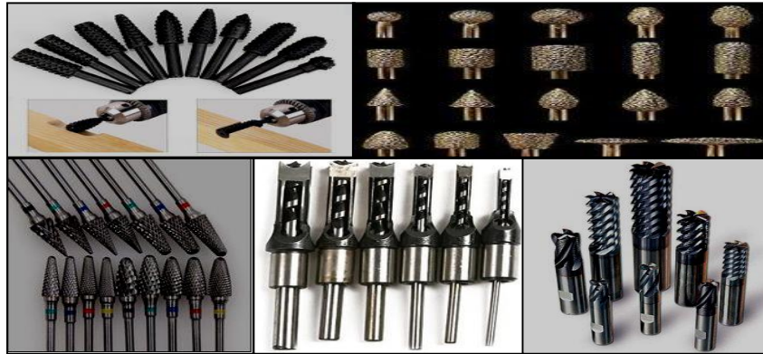
شكل (١١) يوضح تنوع البنت الحديدية المستخدمة في تشكيل العصا الخشبية
