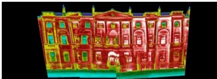
الشكل ٨ : تكوين صورة حرارية تُظهر فقدان الحرارة من مبني تراثي
