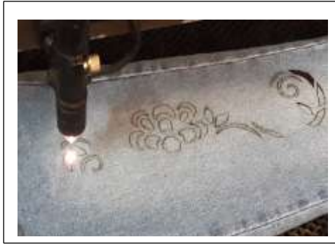
صورة (4) شعاع الليزر يقص القماش طبقاً للتصميم
