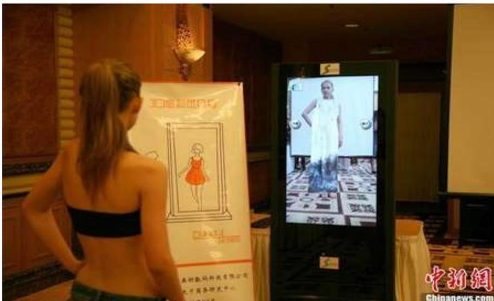
شكل (1) وحدة قياس الملابس الافتراضية التفاعلية
