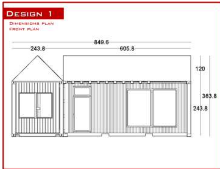
شكل رقم 6 (د) المسقط الجانبي يوضح الفتحات والابواب والشكل الخارجي
