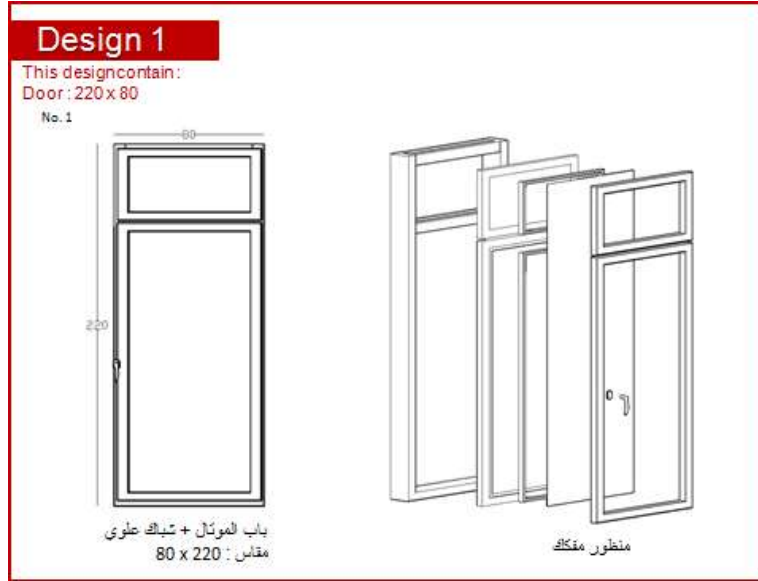
شكل رقم 6 (و) يوضح منظور مفكك للباب الالومنيوم
