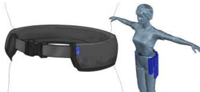
شكل 4 تطوير حزام يمكن أن يستشعر الحركة ويتضخم ليشكل وسادة هوائية ليمنع وقوع الإصابات والكسور الناجمة عن السقوط (Liszewski 2014)
