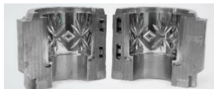
شكل ٣ يوضح القالب المشكل به التصميم في البدن
