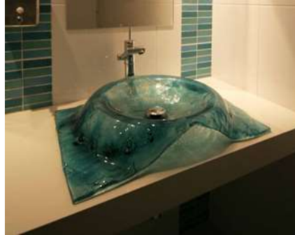
شكل (11) يوضح الأحواض المنتجة بطريقة الثني الحراري ومكملاتها
